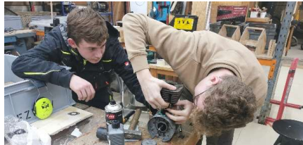
Bild: Ein Seifenkistenbauer der 1. Stunde ist in Ausbildung zum Polymechniker und repariert einen alten Töfflimotor
